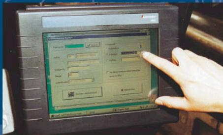
**MoTIS® FLS** ist flexibel einsetzbar vom einfachen textbasierten Terminal bis zum Mobile-PC mit Touchscreen. Integrierte Scanner für Barcode und RFID, Waagen und Etikettendrucker machen den Stapler zu einem vollwertigen Arbeitsplatz.
